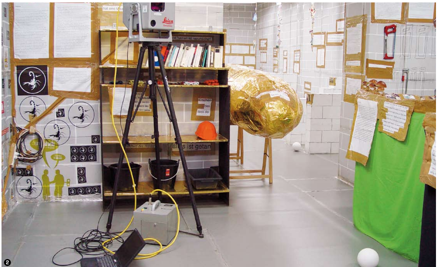
1 Tacheometric measurement used for photogrammetric rectification of the images. PHOTO Bayerische Staatsgemäldesammlungen [Maïke Grün], Munich; COPYRIGHT Bayerische Staatsgemäldesammlungen; COPYRIGHT VG Bild-Kunst, Bonn, 2010. 2 Surveying with a laser scanner. There are two white control balls lying on the floor. PHOTO Bayerische Staatsgemäldesammlungen [Maïke Grün], Munich; COPYRIGHT Bayerische Staatsgemäldesammlungen; COPYRIGHT VG Bild-Kunst, Bonn, 2010.
