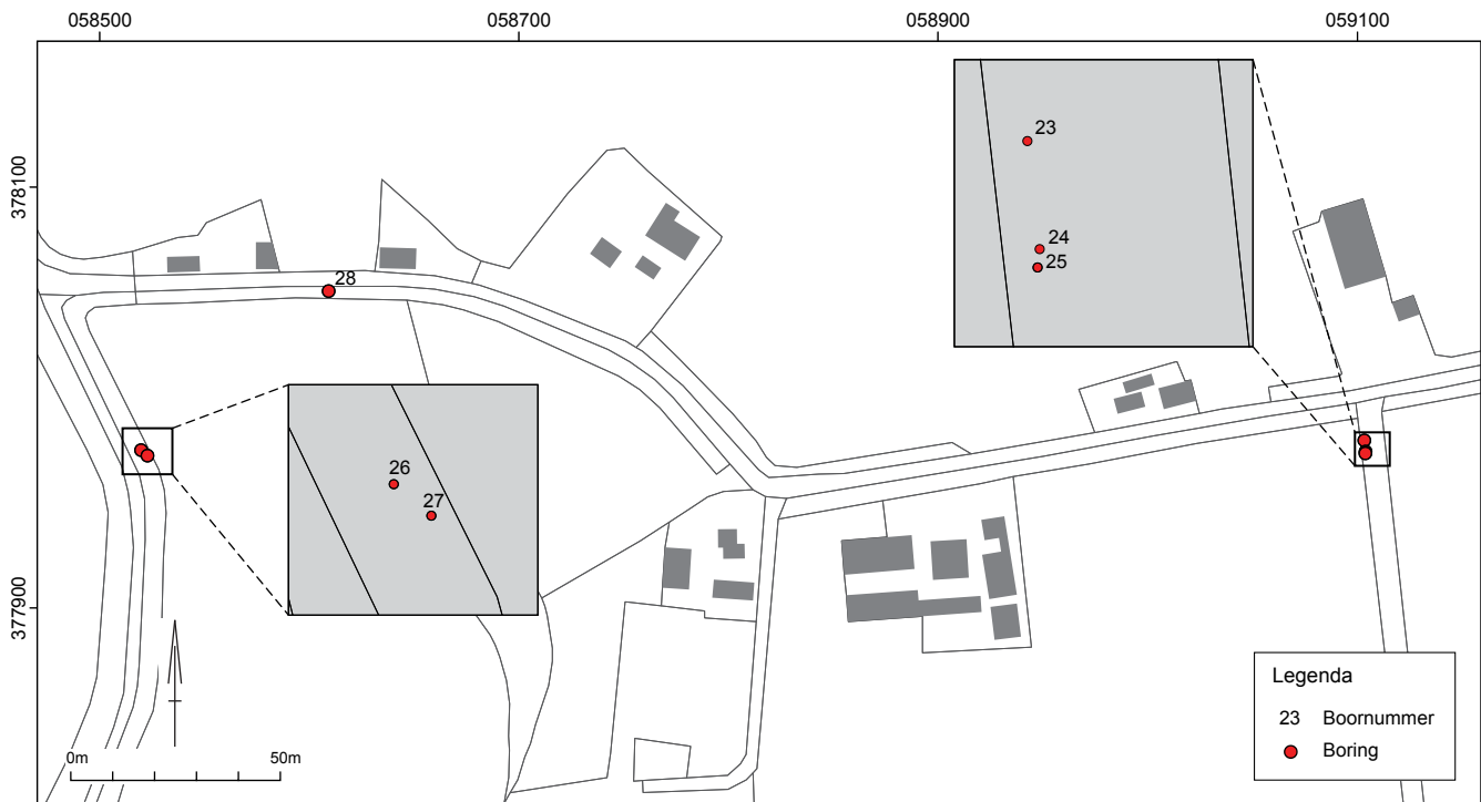
Afb. 25 Locatie van de boorpunten in drie onderzochte delen van de dijklichamen.
