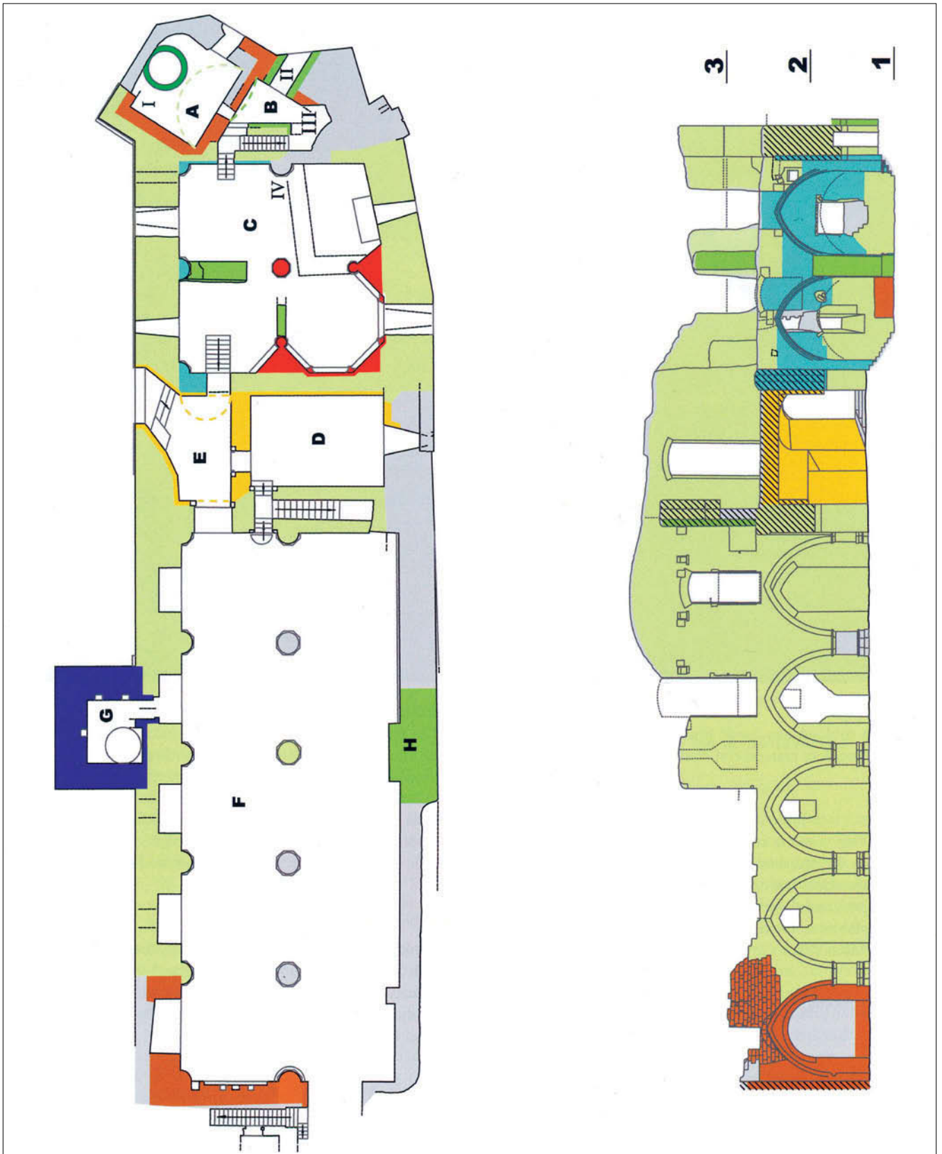
Afb. 55 Plattegrond en langsdoorsnede van de hoofdvluegel met waargenomen bouwfasen. Legenda: lichtgroen, late 12e/13e eeuw; donkerblauw, 14e eeuw; lichtblauw/rood/oranje, 15e-vroege 16e eeuw; groen, Tachtigjarige Oorlog (1568-1648); donkergroen, onbekende datering (bron: Soengerath 2010).
