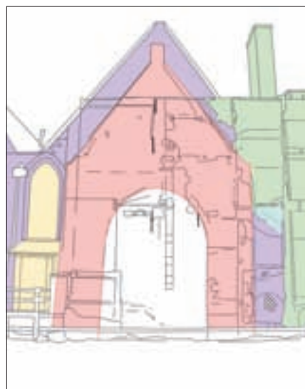
De achterzijde van de Waalse kerk, Breestraat 62 te Leiden. In de gevel is de tuitgevel van de verdwenen koorpartij zichtbaar, met daarin de open triomfboog tussen koor en schip. De tekeningen verduidelijken de verschillende bouwsporen. Herkomst: Unit Monumenten en Archeologie, gemeente Leiden.
