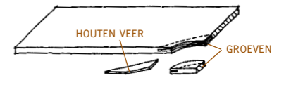
Het repareren van een gebroken hoek
