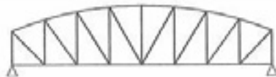
Vakwerkliggerbrug Het vakwerk heeft bij deze vorm een gebogen bovenrand. Deze vorm volgt zoveel mogelijk de momentenlijn, waardoor een efficiënt materiaalgebruik mogelijk is.
