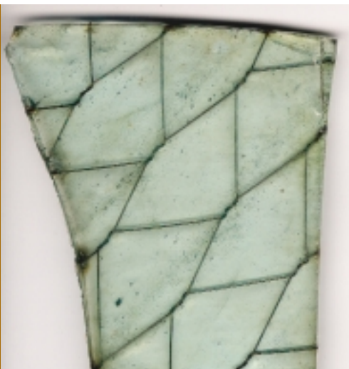
Oud draadglas met daarin kippengaas aangebracht
