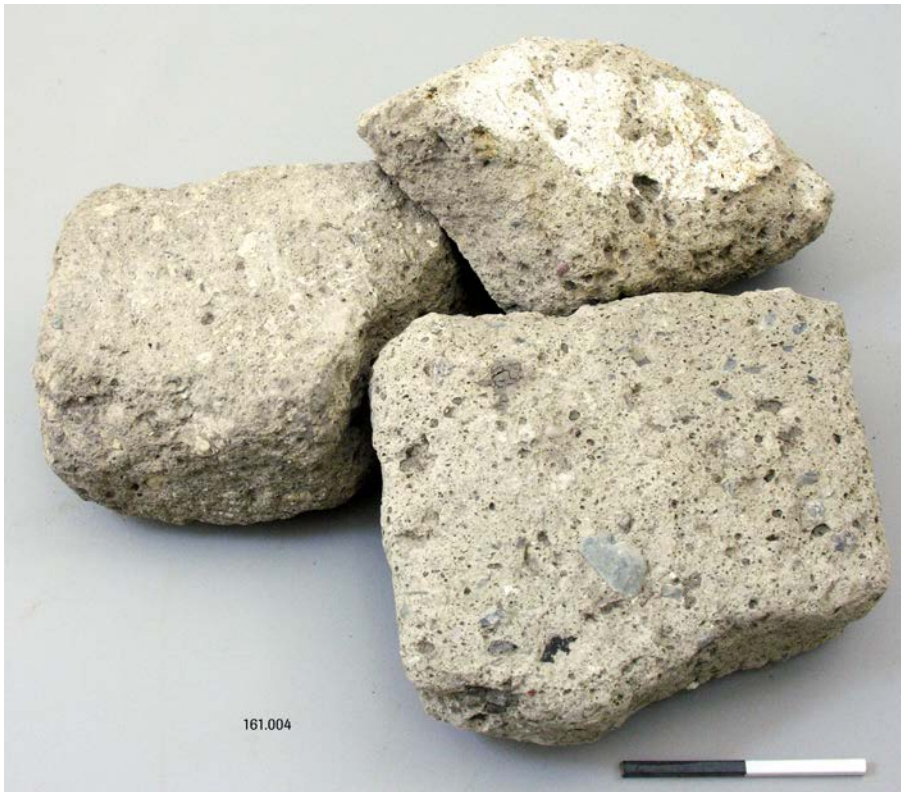
Afb. 6.6 Blokvormige brokken tufsteen met mortelresten van een eerdere bouwphase, toegepast in een vierde-eeuwse fundering van het Ewijk Monument. (Foto: ADC ArcheoProjecten)
